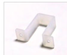
Монтажная скоба, силикон. 30.6x10x22.5mm (ДxШxВ) На каждый метр светильника требуется не менее 3-х клипс
