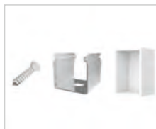
Монтажная клипса из нержавеющей стали и заглушка светильника. 15x13.8x12.1mm (ДxШxВ) На каждый метр светильника требуется не менее 3-х клипс
