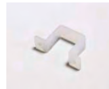
Монтажная скоба, силикон. 34.6x10x16.5мм (ДxШxВ) На каждый метр светильника требуется не менее 3-х клипс
