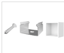
Монтажная клипса из нержавеющей стали и заглушка светильника. 15x18.2x10.1мм (ДxШxВ) На каждый метр светильника требуется не менее 3-х клипс
