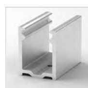
Монтажная клипса из алюминия. 20x17,5x22,9мм (ДxШxВ) На каждый метр светильника требуется не менее 3-х клипс
