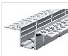
Встраиваемый в гипсокартон алюминиевый профиль, гибкий: 1000x60.2x20.8мм (ДxШxВ) Материал: алюминий Цвет: серебристый
