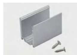
Алюминиевая монтажная клипса: 15x8x13,5мм (ДxШxВ) На каждый метр светильника требуется не менее 3-х клипс
