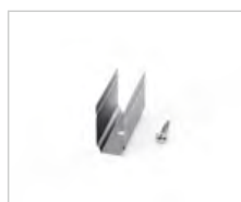
Монтажная клипса из нержавеющей стали: 15x6,8x12,8мм (ДxШxВ) На каждый метр светильника требуется не менее 3-х клипс
