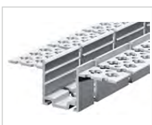
Встраиваемый в гипсокартон алюминиевый профиль, гибкий: 1000x60.2x20.8мм (ДxШxВ)
