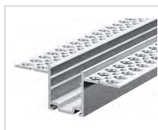
Встраиваемый в гипсокартон алюминиевый профиль: 1000x60.2x20.8мм (ДxШxВ)
