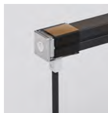
Коннектор подключения питания к светильнику 27.9x20.4x19.4мм (ДxШxВ) Ввод кабеля: снизу
