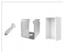
Монтажная клипса из нержавеющей стали и заглушка светильника. 8x12.1x7.7мм (ДхШхВ) На каждый метр светильника требуется не менее 3-х клипс
