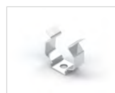
Монтажная клипса из нержавеющей стали. 11,6x8x7,6мм (ДхШхВ) На каждый метр светильника требуется не менее 3-х клипс
